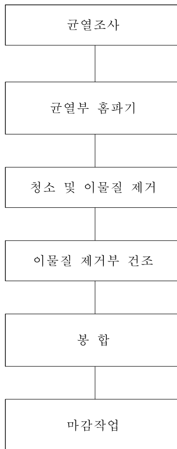
<그림 4.2.14> 교면포장 아스팔트 균열보수
